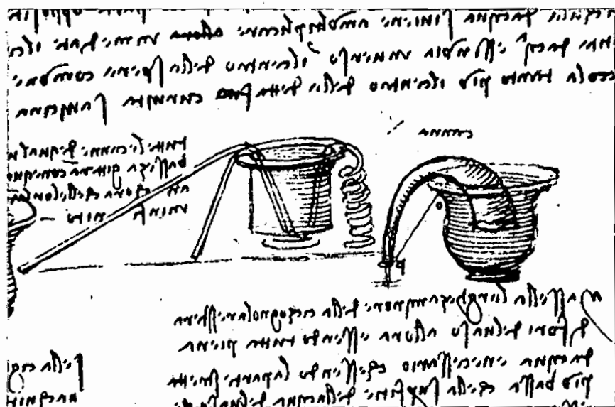
Fig. 6. Experimentos con sifones.
